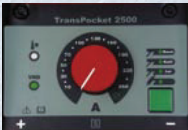
Elektroden lassen en extra TIG-functie. Grote draaiknop voor eenvoudige bediening, ook met handschoenen.
